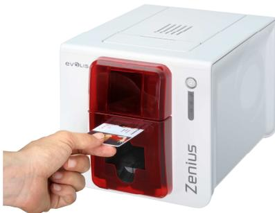
Son impresoras de transferencia térmica o sublimación, capaces de imprimir directamente sobre plástico PVC en tarjetas ISO CR-80 o ISO-7810 (tipo tarjeta crédito). Existen modelos monocromo y color y modelos capaces de imprimir por las dos caras sin necesidad de voltear las tarjetas.
