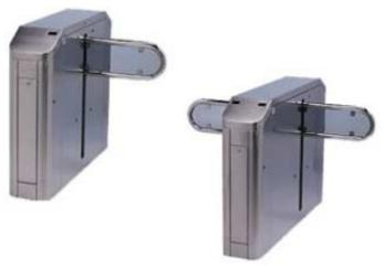
El sistema consiste en un mueble de cuyo lateral sale una pala de tubo, la pala permanece siempre levantada cerrando el paso y solo se retira basculando hacia abajo y escondiéndose en el mueble cuando recibe una señal de autorización de acceso desde un lector o pulsador. Funcionamiento eléctrico y sentido de paso uni o bidereccional.
