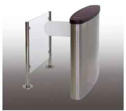
El sistema consiste en un mueble de cuyo lateral sale una pala de cristal, la pala permanece siempre levantada cerrando el paso y solo se retira basculando hacia abajo y escondiéndose en el mueble cuando recibe una señal de autorización de acceso desde un lector o pulsador. Necesita baranda de canalización para células fotoeléctricas. Funcionamiento eléctrico y sentido de paso uni o bidereccional.
